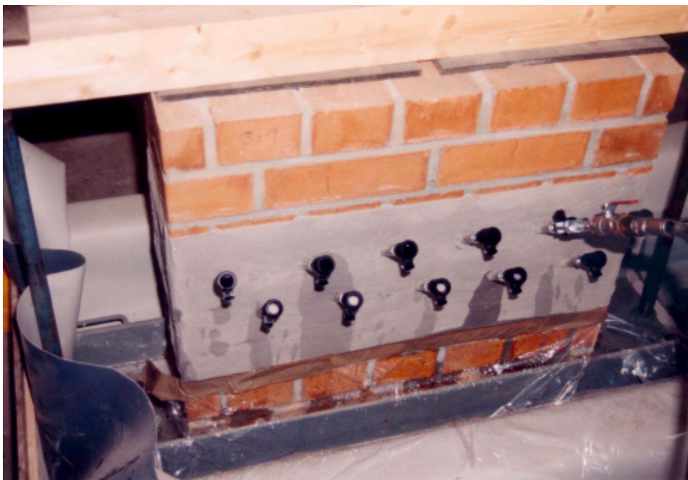
Bild 2: Gelinjektion in einen Mauerwerksprobekörper mit Umgebungsfeuchte
